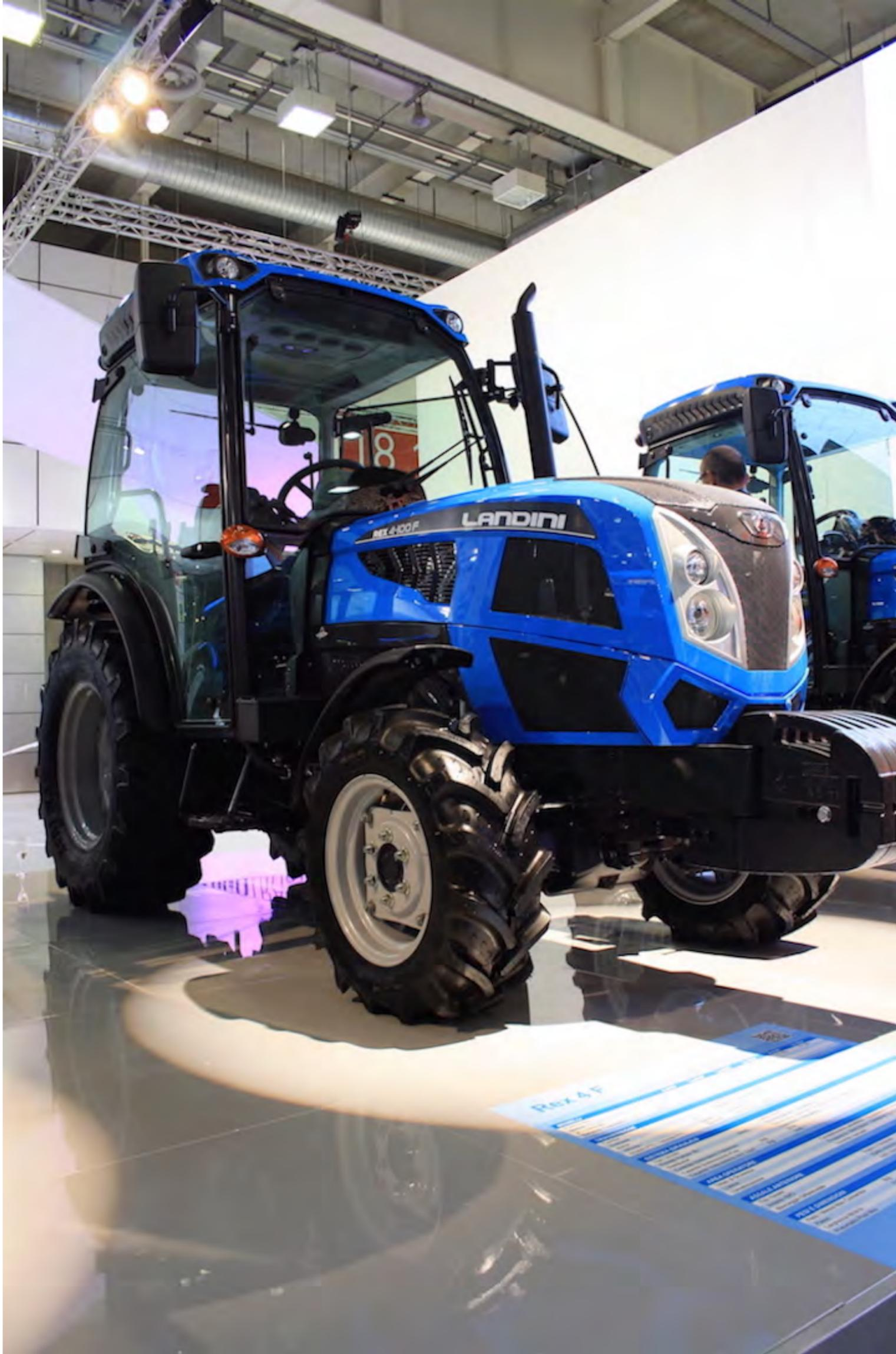
A 2 o 4 **ruote motrici**, con pneumatici posteriori da 24", 28" e, per la versione GT, addirittura 30", la nuova serie Rex 4 grazie alle **dimensioni ridotte** e ad un **angolo di sterzata** di 55 gradi, offre prestazioni eccezionali in termini di **maneggevolezza**. Per agevolare la sterzata la versione vigneto dispone di un **assale High Pivot** dedicato con basculamento maggiorato.
